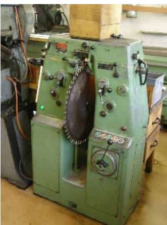
Präziser Vollmer Schränkautomat für CV-Sägen, mit Museumscharakter
